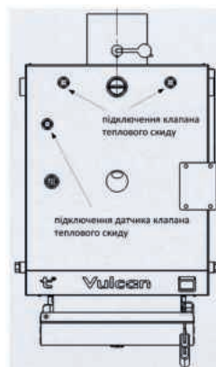
Рис.6 Підключення системи термічного розвантаження
