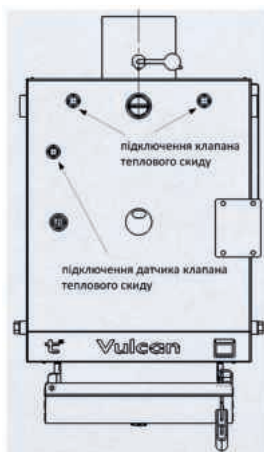
Рис.10 Підключення системи термічного розвантаження
